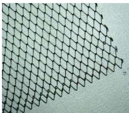
Figura 12 – Ilustração da tela galvânica G utilizada em pilar. (fonte: rogertec).
